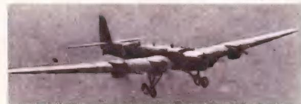
моторнодолах находился основной запас горючего — 300 кг, обеспечивающий дальность полета 980 км. С дополнительным топливом дальность доходила до 2160 км.
